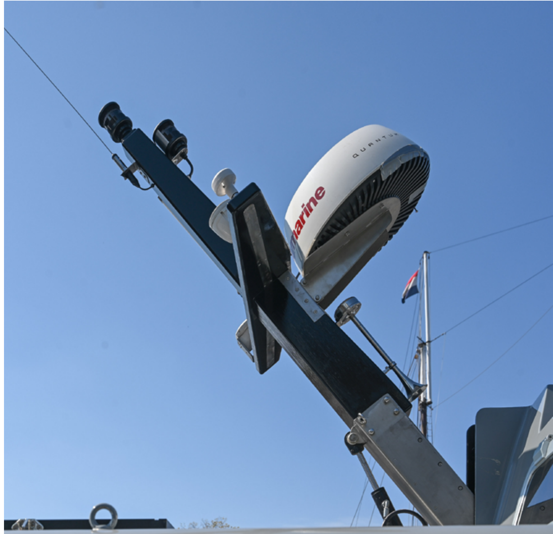
Vanaf de stuurstand traploos hydraulisch neerklapbaar
