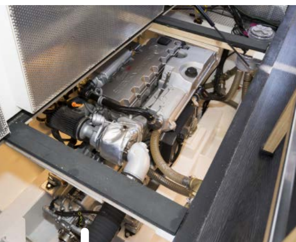
Boven de nette motorkamer ligt een goed geïsoleerd motorluik met lood/rubber platen, steenwol en geperforeerde metaalplaat.
